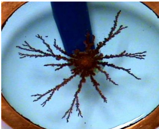
Rys.2. Wzrosty \text{CuSO}_4 a) 0,01M – 12V, b) 0,03M – 12V, c) 0,5M – 12V, d) 1M – 10V
