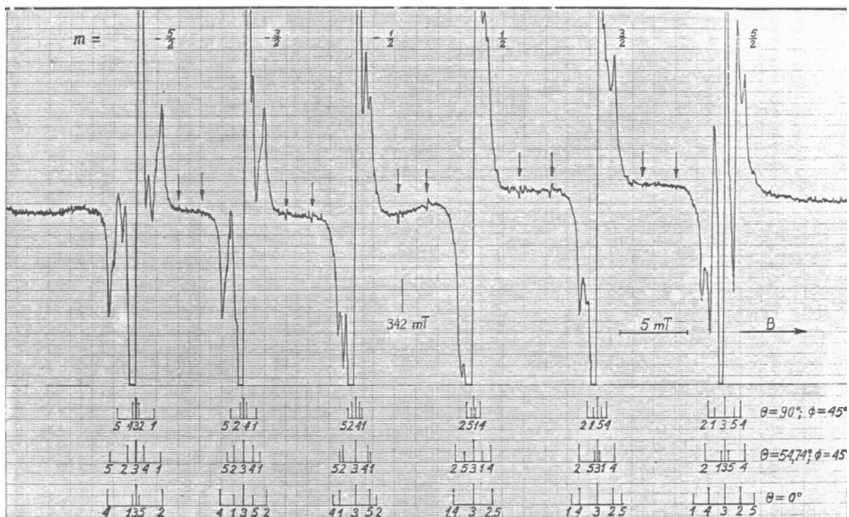
Rys. 2. Doświadczalne widmo proszkowe jonów Mn^{2+} w regularnej sieci CaO i obliczone położenia pików pełnej struktury widma dozwolonego z wykorzystaniem zależności ujętych w tabeli 1. W obliczeniach przyjęto B_0 = 342,8 mT, A = -8,65 mT, a = 0,6 mT, g = 2,001 .
