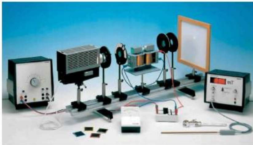
Rys. 6: Zestawienie układu do zjawiska Faradaya
