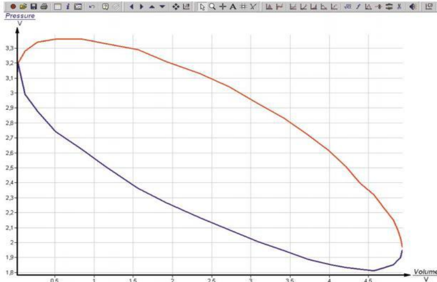
Rys.3 Ciśnienie w funkcji objętości w rzeczywistym, zamkniętym cyklu Stirlinga.
